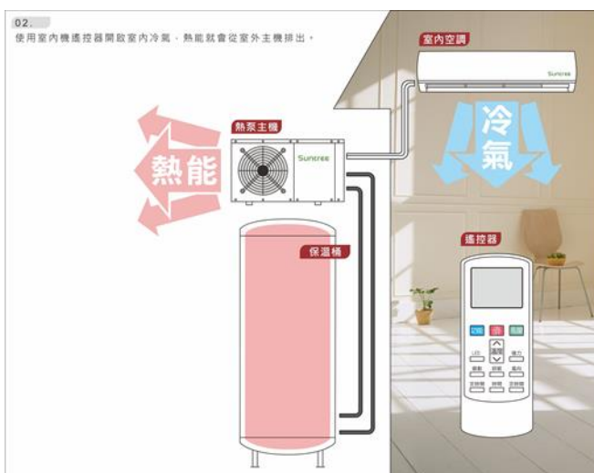
02.使用室內機遙控器開啟室內冷氣，熱能就會從室外主機排出。
