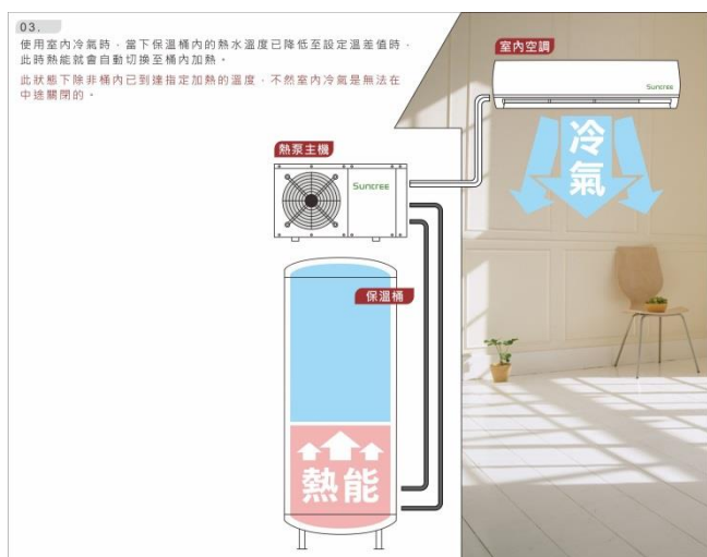
03.使用室內冷氣時，當保溫桶內的熱水溫度已降低至設定溫差值時，此時熱能就會自動切換至桶內加熱。
