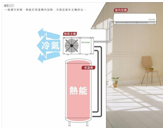
01.一般運行狀態，熱能於保溫桶內加熱，冷氣從室外主機排出。
