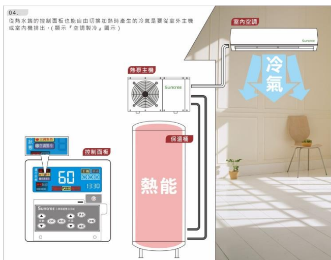
04.從熱水端的控制面板也能自由切換加熱時產生的冷氣是要從室外主機或室內機排出。
